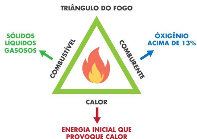
Uma fonte de ignição pode ter origem não só nos equipamentos elétricos, mas também em vários lugares diferentes. Assim, ela pode surgir a partir do centelhamento e do calor gerado pelos equipamentos, nas descargas atmosféricas, a partir da energia estática que pode ser gerada em diversos locais, centelhamento provocado por atrito, entre outras condições e locais.
