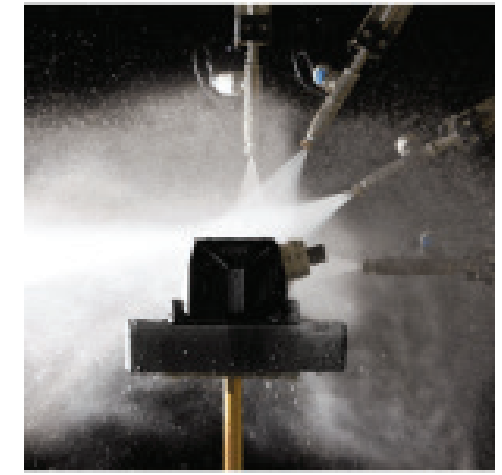
Teste de resistência à água, jato d'água multidirecional
